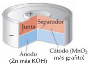
▲ Figura 20.21 Vista de un corte de una batería alcalina en miniatura.
